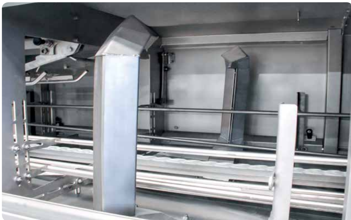
Section interne de l'EAB-1-ST, les lames d'air 'coupent' l'eau résiduelle du bac
